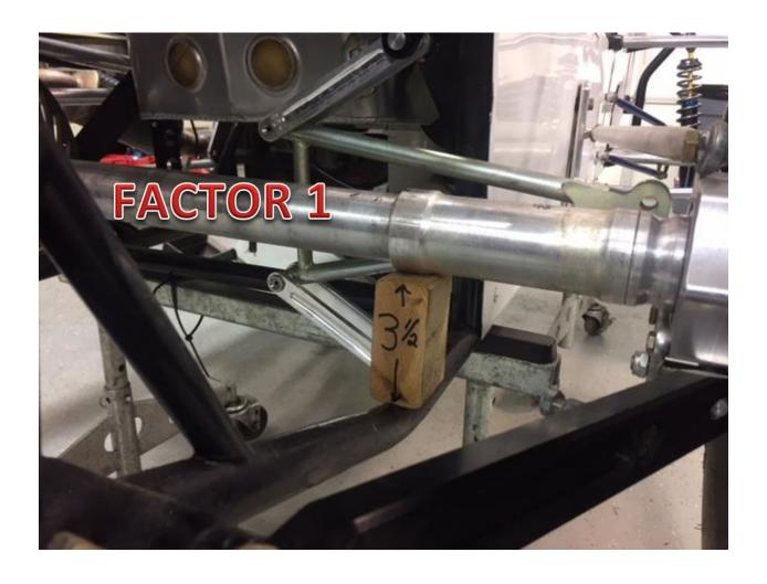
I MAKE SOME RIDE HEIGHT BLOCKS TO PUT UNDER THE AXEL TO SIMULATE DRIVER IN CAR
